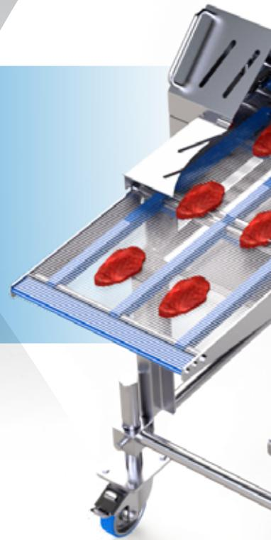
Der alco Steaker nutzt Messerwalzen um Muskelstrukturen des Fleisches zu zerstören und somit in industriellem Maßstab ein zartes Produkt zu erzielen
