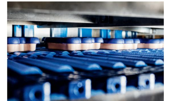
Durch die horizontale Luftführung wird die Bärchenstreichwurst von Reinert über alle Etagen mit der gleichen Temperatur gleichmäßig gekühlt.
