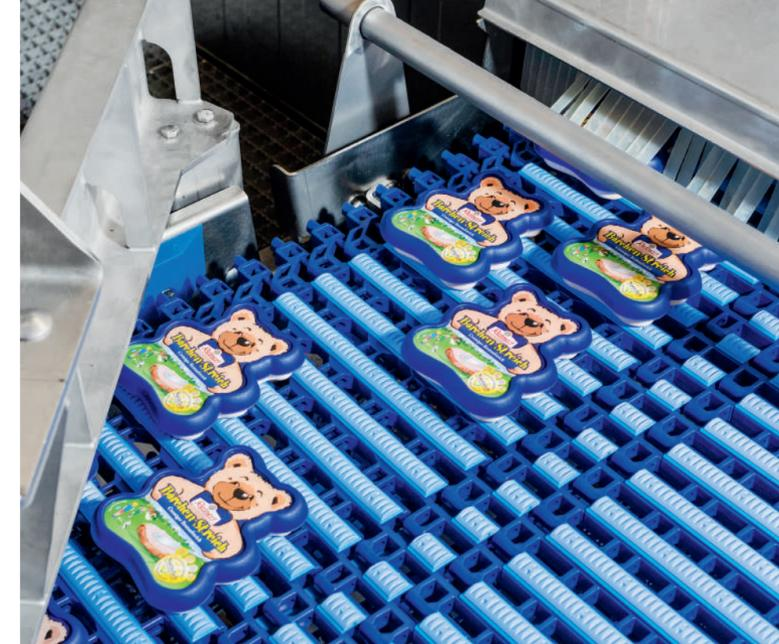
Ein speziell gummierter Gurt sowie das DirectDrive-Antriebssystem gewährleisten einen ruhigen Bandverlauf und die exakte Beibehaltung der Position der Produkte.
